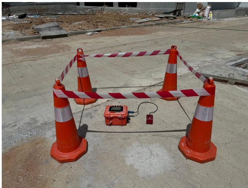
รูปที่ 4.3.3-1 แสดงการตรวจวัดความสั่นสะเทือน (ภายในพื้นที่โครงการ)
